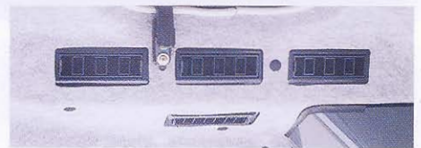
▲上部吹き出しクーラー
