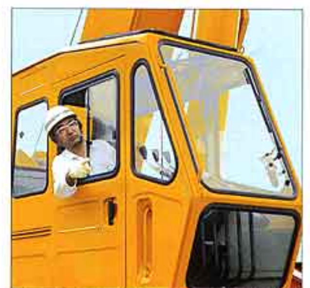
●窓から顔が出せる「コミュニケーションウインド」を採用。
