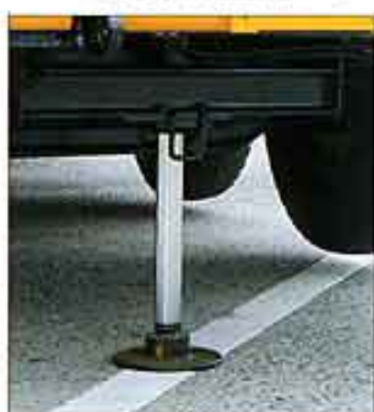
広い全周同一吊り上げ性能を發揮する油圧式フロントジャッキ
