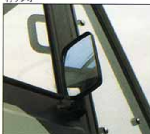
●作業時の後方確認が容易になったサイドミラーとドアミラー
