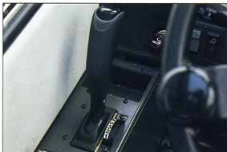
●OD付電子制御フルロックアップオートマチックトランスミッション
