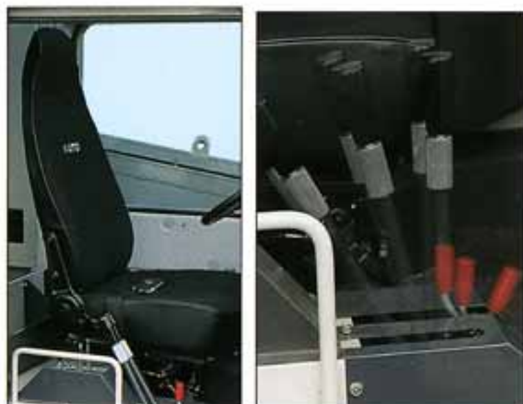
●ホールド性抜群の高級クロス張りフルリクライニングシート ●オペレータの体格、作業内容に応じて最適な位置が調整可能、チルト式操作レバー
